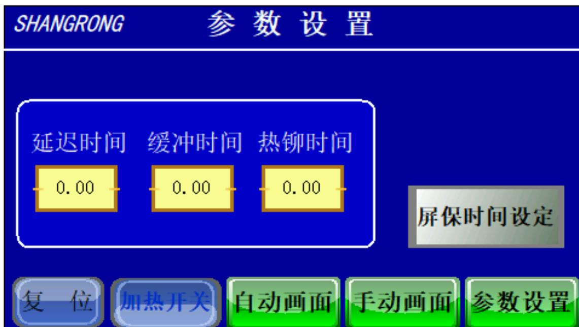
自动过程：启动→延迟时间→减速（缓冲时间）→热铆时间→热铆结束回原点。
