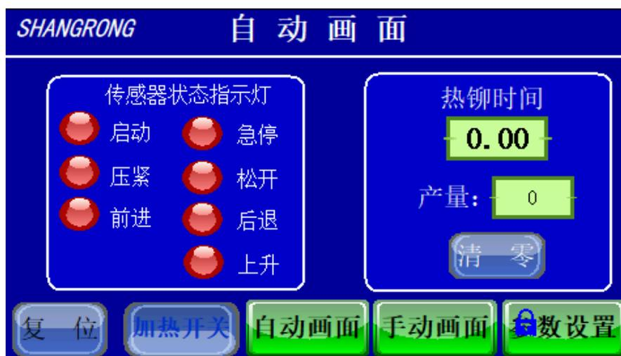
温度开关：**加热开关** 注：**加热开关**状态表示未启动，开机后先检查是否已经启动。
